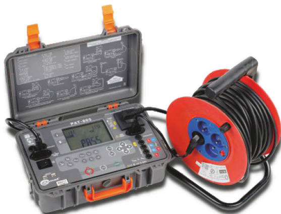
Fig. 21. Testarea prelungitoarelor cu instrumentul PAT-805
