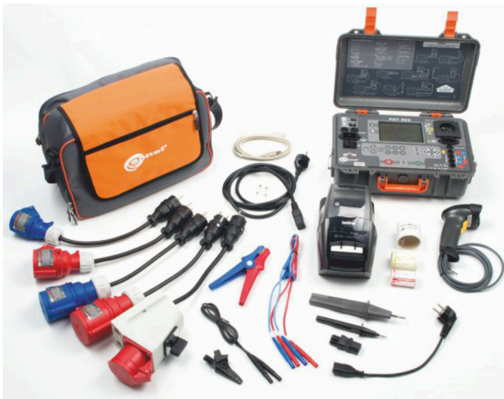
aFig. 30 Instrumentu PAT-805 cu accesoriile de bază și opționale
